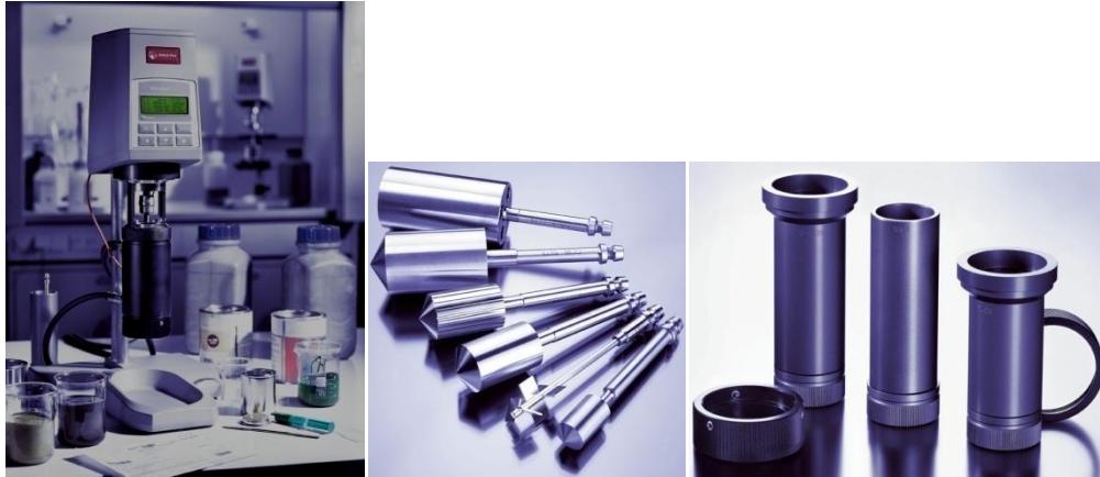
Figura 2. a) Viscosímetro rotacional marca Anton-Paar, b) geometrías de flujo: cilindros concéntricos y paletas. c) copas para depositar el fluido a caracterizar en el viscosímetro.
